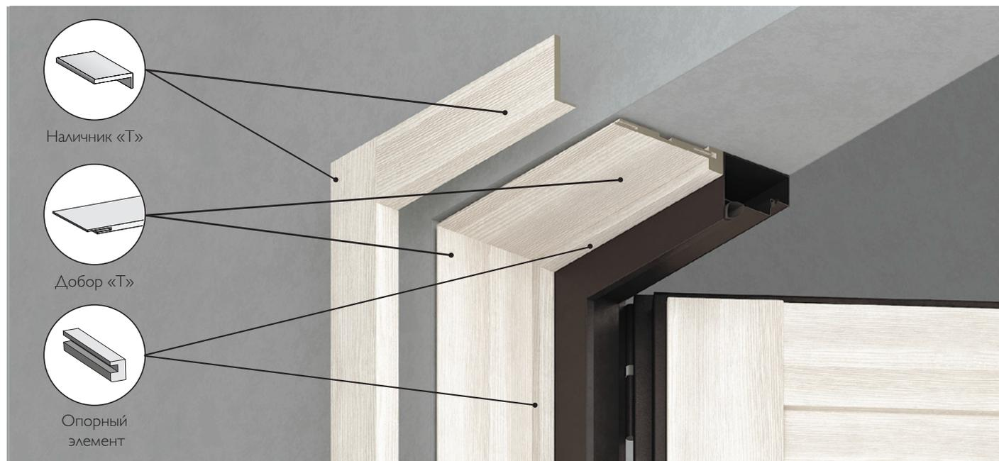
СХЕМА СОЕДИНЕНИЯ ДОБОРОВ С ИСПОЛЬЗОВАНИЕМ ШПОНКИ
